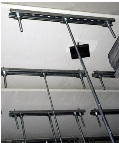
Abb. 1a: Eine für die Brandprüfung vorbereitete MÜPRO MPR-Systemschiene in der Brennkammer.
