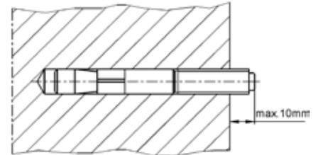
Befestigung am Baukörper:
