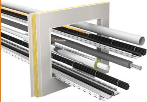
3. Durchbruch umlaufend mit Kreppband mit 25 mm Abstand zur Kante abkleben. Kabel mit PYRO-SAFE FLAMMOTECT-A im Bereich der Mineralfaserplatten beschichten.
