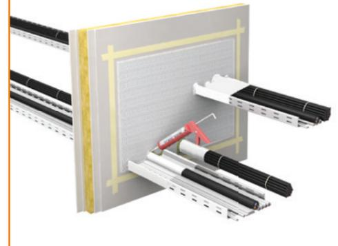
8. Schlussanstrich mit PYRO-SAFE FLAMMOTECT-A Farbe. (Trockenschichtdicke  $\geq 1$  mm)
