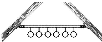
Montage einer Rohrtrasse am geneigten Dachbinder
