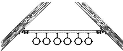
Montage einer Rohrtrasse am geneigten Dachbinder
