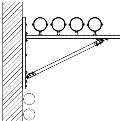
Rohrinstallation an einer Konsole mit Druckstrebe
