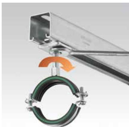
Gewindestift in den MPR-Schnellbefestiger eindrehen und mit Sechskantmutter kontern. Anschließend Rohrschelle montieren.
