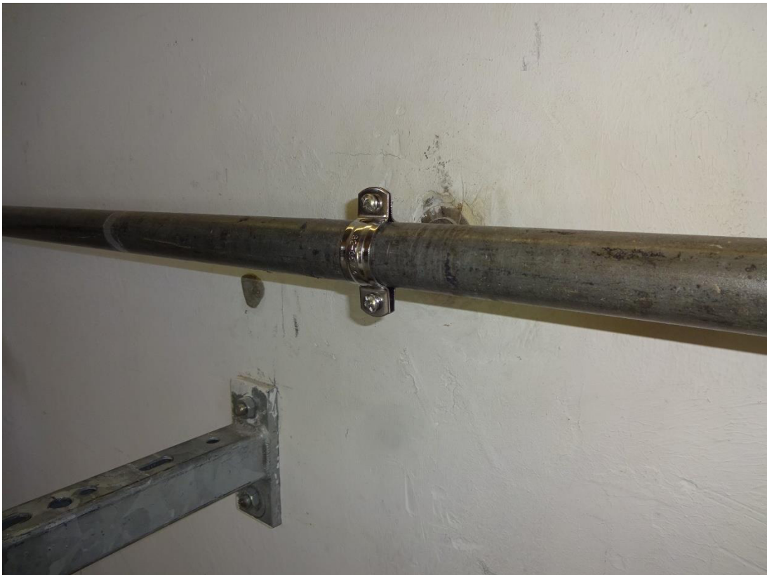
Bild 2: Bezugsmessung: V2A Schelle ohne Dämmeinlage, 1" (32 - 35 mm), Anschluss M8/10, starrer Anschluss
