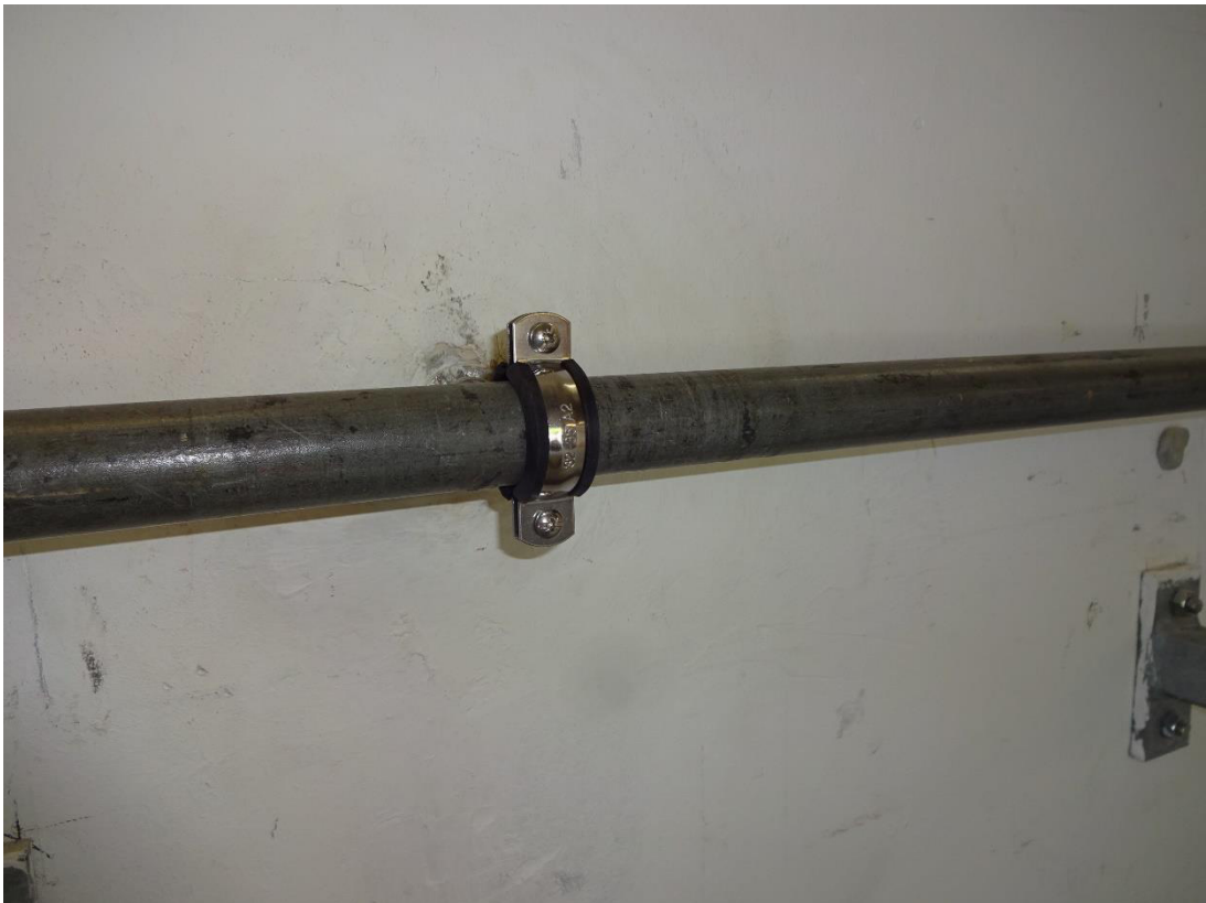
Bild 4: Messung 1: V2A Schraubrohrschele DÄMMGULAST®, schwarz, 1" (32 - 35 mm), Anschluss M8/10
